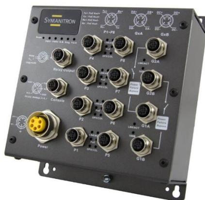
*рис.17 Промышленный транспортный коммутатор с «медными» bypass-портами и разъемами M12.*
